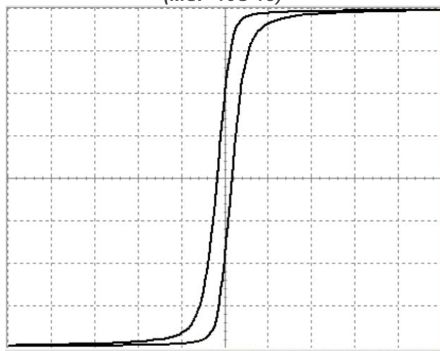
Типовая петля гистерезиса В-Н при 10 КHz, 80 А/м (MSP-10S-18)
